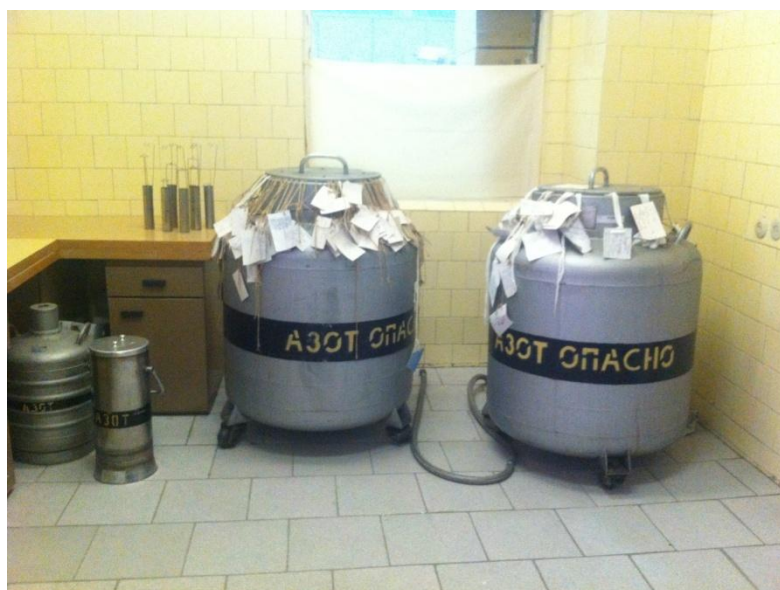
Рис. 32. Стационарные бункеры для содержания дендритноклеточной вакцины в криохранилище Банка долговременного хранения биологического материала НИИ онкологии им. Н.Н. Петрова.
