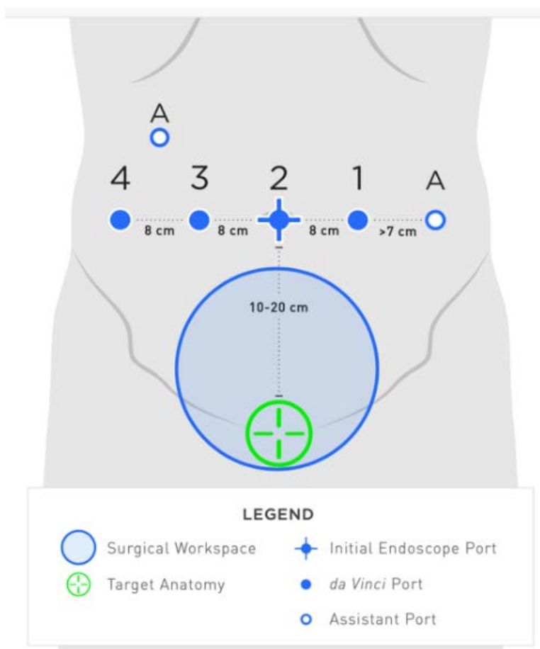
Рис. 9. Схема расстановки рабочих троакаров при РАПЦЭ при использовании системы Da Vinci XI, предлагаемая CLINICAL SPECIALTY GUIDE, Intuitive Surgery®.
