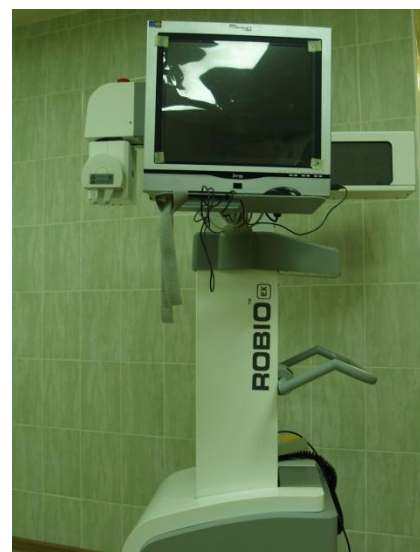
Рисунок 2.12. Роботизированная системы для стереотаксической биопсии «Robio EX», совмещённая с компьютерным томографом Somatom Definition AS 128.
