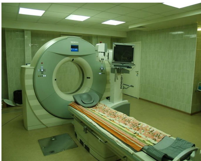
Рисунок 2.12. Роботизированная системы для стереотаксической биопсии «Robio EX», совмещённая с компьютерным томографом Somatom Definition AS 128.
